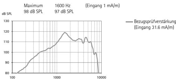
Empfindlichkeit der Induktionsspule
